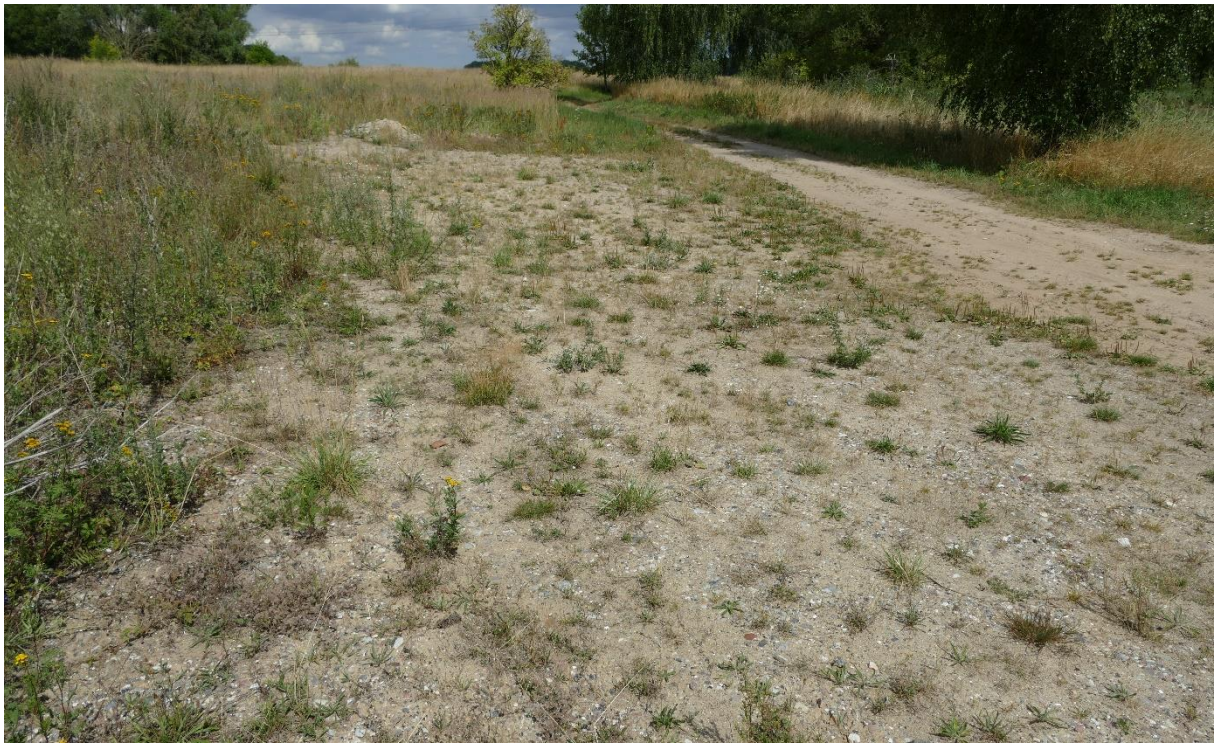
Bild 02: Verdichteter Boden durch Materialeintrag von Gebäudeabrissen
